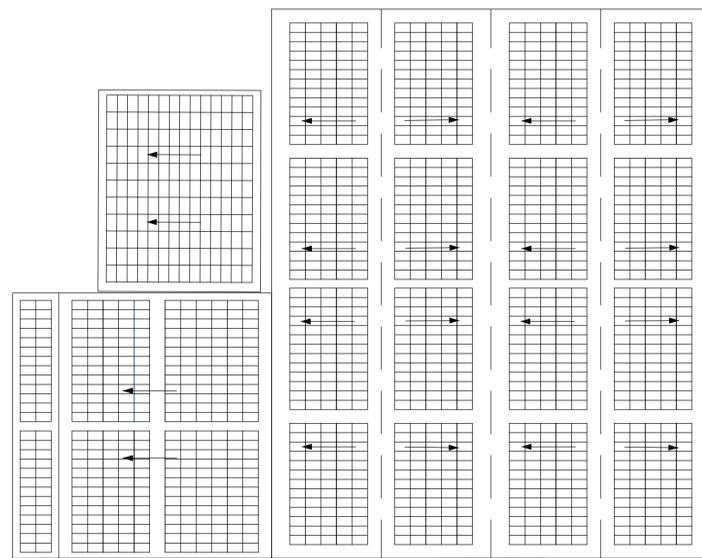
Pianta coperture con schema impianto fotovoltaico - 1:500
